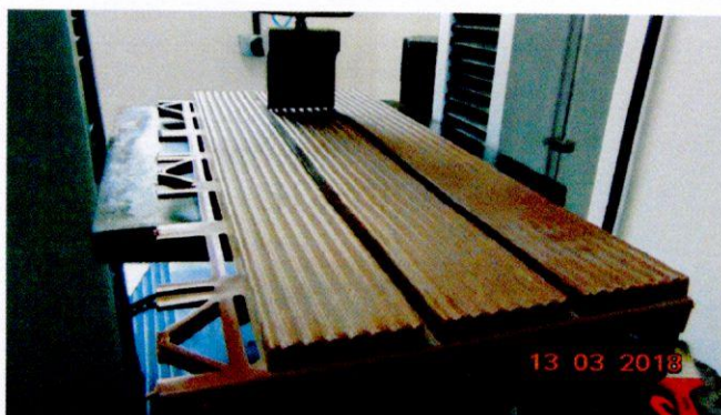
Ensaio de flexão entre torres sem travessa
