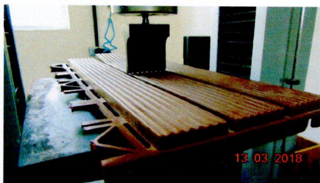
Ensaio de flexão entre torres com parafuso
