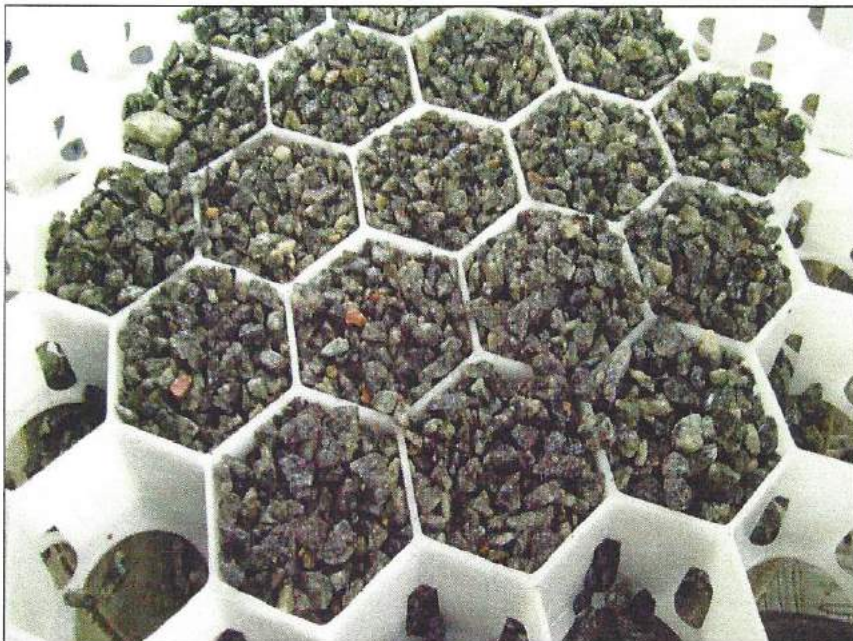
Figura 06: Corpo-de-prova com brita para realização do ensaio de compressão.
