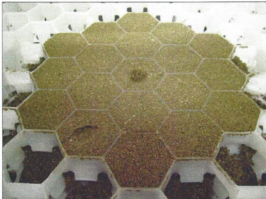
Figura 07: Corpo-de-prova após a realização do ensaio de compressão com areia.
