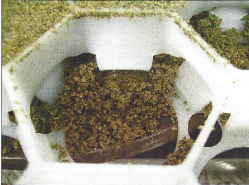
Figura 08: Corpo-de-prova após a realização do ensaio de compressão com areia.
