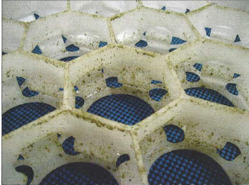
Figura 10: Corpo-de-prova após a realização do ensaio de compressão com areia.
