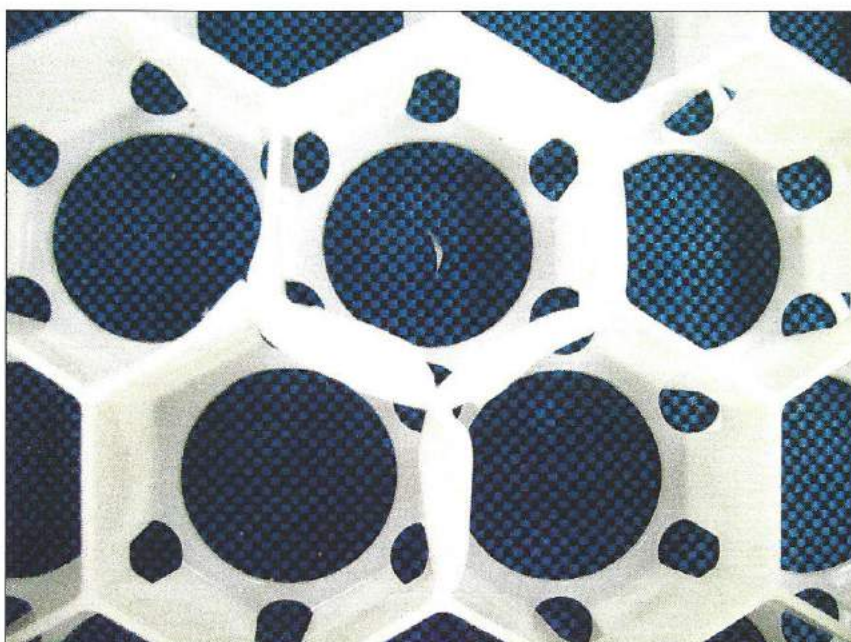
Figura 03: Corpo-de-prova após a realização do ensaio de impacto.
