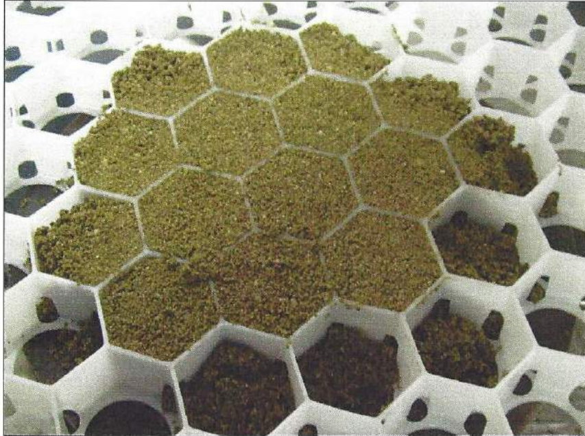
Figura 05: Corpo-de-prova com areia para realização do ensaio de compressão.
