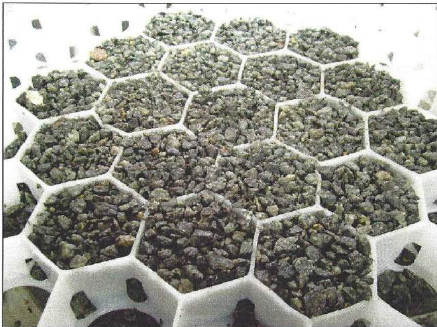
Figura 11: Corpo-de-prova após a realização do ensaio de compressão com brita.
