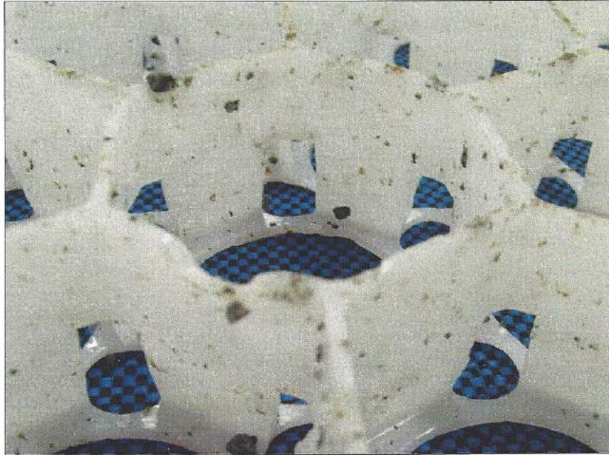
Figura 14: Corpo-de-prova após a realização do ensaio de compressão com brita.
