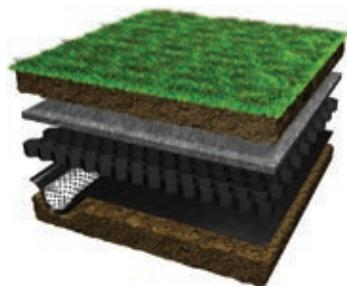
Um piso mais estável com menos água na superfície resultam em um gramado mais saudável e bonito. O sistema de drenagem completa o campo inteiro sem problemas de entupimentos e fadiga em tubos de drenagem convencionais. Maior enraizamento e menor perda de material de base no solo, menos escavação e maior proteção das raízes.
