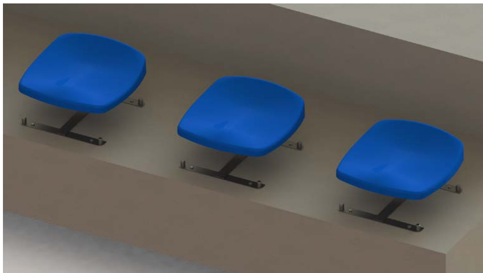
Figura 5 – Fixação dos assentos
