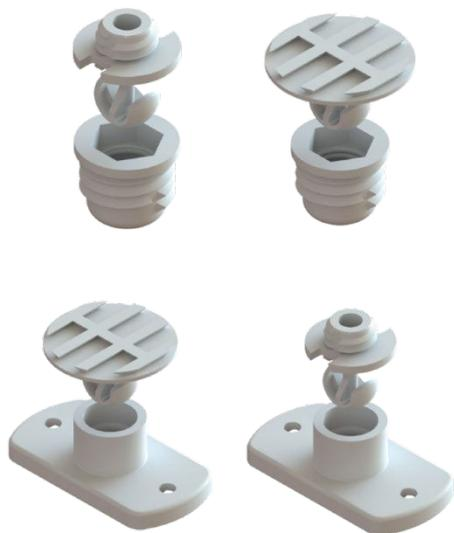
O sistema de fixação que revolucionou a forma de montagem de painéis. Os painéis podem ser facilmente removidos e recolocados sem a necessidade de parafusos, suportes e peças de encaixes. Projetados para fixar chapas de vidro, plástico, madeira, OSB e MDF. Possui alta resistência a cargas (05 kg/par - clip macho e fêmea), requisitos de folga variáveis e alta resistência ao cisalhamento.
