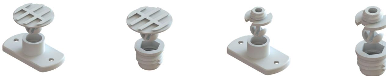
Onde uma cavidade é necessária ou onde os instaladores preferem uma montagem fixada em parafuso, use clips concebidos para auto-rosqueamento e/ou a peça fêmea com fixação por parafusos. Utilize o clips macho com fixação por meio de adesivos ou cola epóxi, pois permite flexão e expansão do painel do quadro de suporte.
